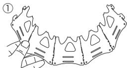
図のように各側面板のツメを合わせ5枚を組合わせます。
