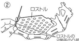
側面板の下から2段目の横長の穴にロストルの2箇所の凸部を差し込みます。
