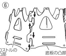
6枚目の側面板の最下部の横長穴に底板の凸部を差し込み、次に側面板の左側のツメをスライドさせて引っ掛けます。カチッという音がするまではめ込みます。
