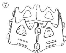
12箇所のツメがしっかりとめ込まれていることを確認します。収納は組み立て時と逆の手順で行ないます。
