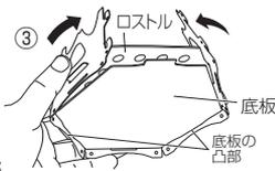
側面板の最下段の横長の穴に底板の2箇所の凸部を差し込みます。ロストルの3箇所目の凸部を差し込みます。ロストルと底板の凸部は互い違いの位置に差し込みます。
