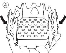
ロストルの3箇所目の凸部、底板の2箇所の凸部が側面板から出るように、また側面板が広がらないように手で保持します。
