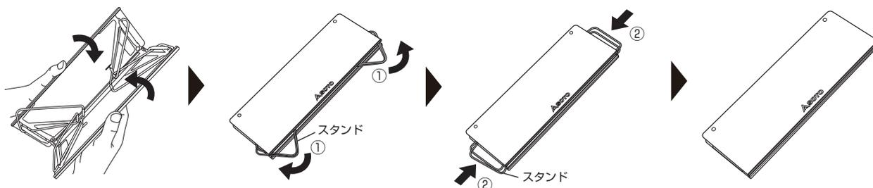
1. 組み立て時と逆の手順でテーブルを閉じます。(スタンドが自動的に収納されます。)
