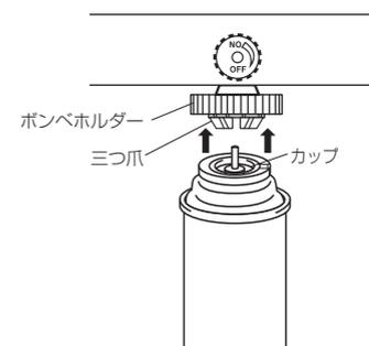
●ボンベホルダーを左方向へ止まるまでしっかりと回して容器(ボンベ)を固定します。
