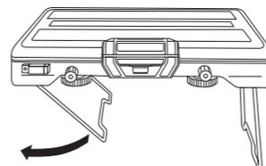
●フックを押し上げながら(図1)フタ(着脱式)を開きます。(図2) (図1) (図2)
