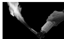
生ガスに点火すると赤い炎が大きく燃え上がり危険です。
