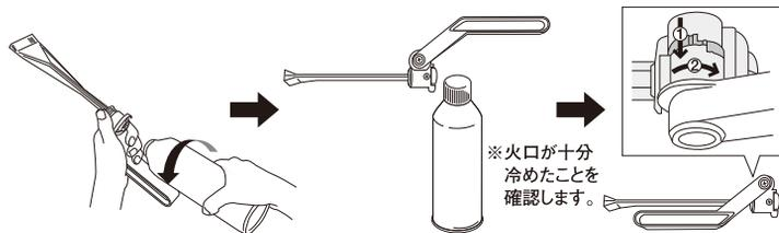
1.バルブカバーを片手で持ち、容器(ボンベ)を点火時と逆の方向(図の矢印方向)に回して消し、本体から容器(ボンベ)も取外します。
