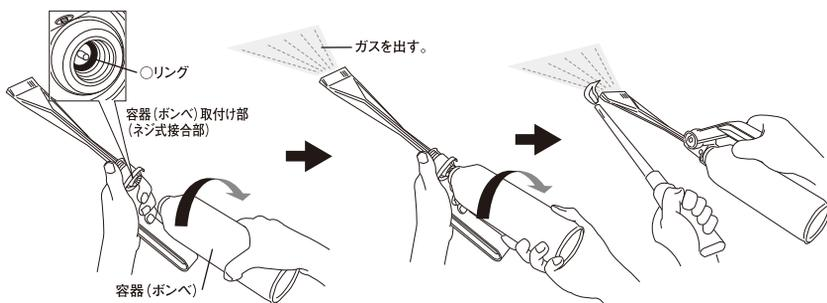
図のようにバルブカバーを片手で持ち、容器(ボンベ)を本体の取付け部(ネジ式接合部)に正しくセットして矢印方向(右ネジ)に止まるまで締め、ガスを出し、速やかにライター等で点火します。
