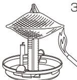
3. マントルの下部よりマッチ、ライターなどで点火します。ガスを出したり止めたりしながら、マントルが完全にボール状の灰になるまで十分に燃やします。
